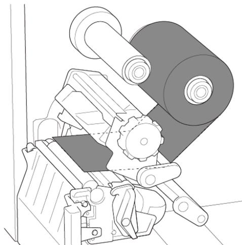
5. Legen Sie den Anfang des Farbbandes auf die Farbband-Rücklaufspindel. Das Farbband muss glatt sein und darf keine Falten aufweisen.
