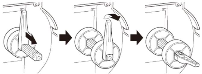
3. 将标签色带放置到标签供应轴上，然后向上翻转标签色带保护轴以将其固定到位。
