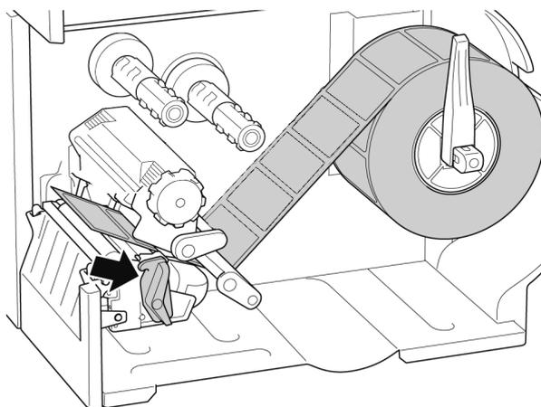
5. Mueva el sensor de medios ajustando el dispositivo de ajuste de posición del sensor de medios. Asegúrese de que la posición del sensor de separación o de marca negra coincida con la posición de la separación/marca negra del rollo de etiquetas.
