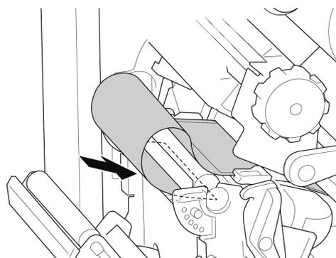
13. Saque el clip de sujeción del soporte del eje de rebobinado del soporte y enrolle el soporte en el eje de rebobinado hasta que quede completamente estirado.
