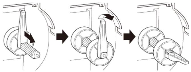
3. Coloque el rollo de etiquetas en el eje de suministro de etiquetas y, después, pliegue el protector del rollo de etiquetas para mantenerlo en su lugar.
