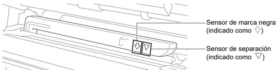
6. Ajuste la guía de etiquetas frontal para fijar la posición de los medios.
