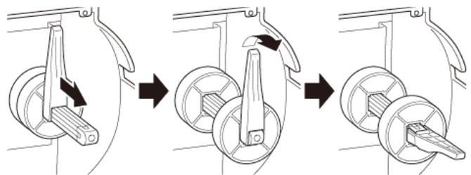
3. Coloque el rollo de etiquetas en el eje de suministro de etiquetas y, después, pliegue el protector del rollo de etiquetas para mantenerlo en su lugar.
