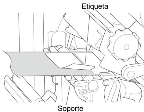
12. Pase el soporte por la ranura de la cubierta del despegador de etiquetas.
