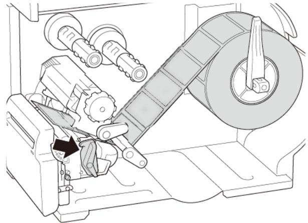
5. Introduzca los medios por la ranura de la cubierta del cortador de etiquetas.
