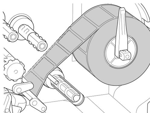
10. Gire la palanca de liberación del cabezal de impresión e inserte aproximadamente 650 mm del rollo de etiquetas a través de la ranura de salida de medios.
