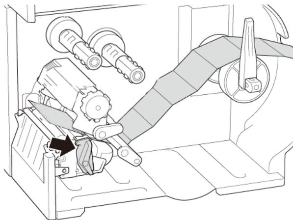
4. Mueva el sensor de medios ajustando el dispositivo de ajuste de posición del sensor de medios. Asegúrese de que la posición del sensor de separación o de marca negra coincida con la posición de la separación/marca negra de la etiqueta.
