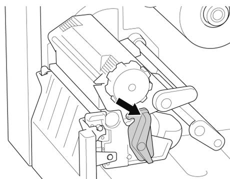
4. Pase la cinta por debajo de la barra de guía de la cinta y a través de la ranura del sensor de cinta siguiendo la ruta de carga impresa en la cubierta de la impresora de etiquetas.
