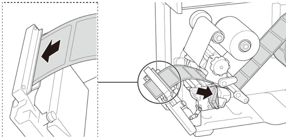
4. Mueva el sensor de medios ajustando el dispositivo de ajuste de posición del sensor de medios. Asegúrese de que la posición del sensor de separación o de marca negra coincida con la posición de la separación/marca negra del rollo de etiquetas.
