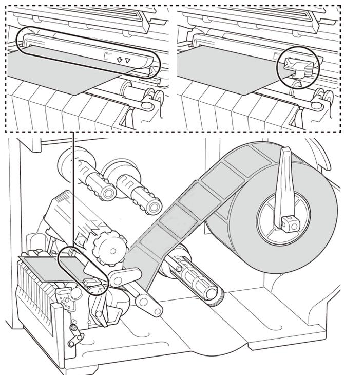
7. Cierre el cabezal de impresión en ambos lados y asegúrese de que encaje en su sitio.
