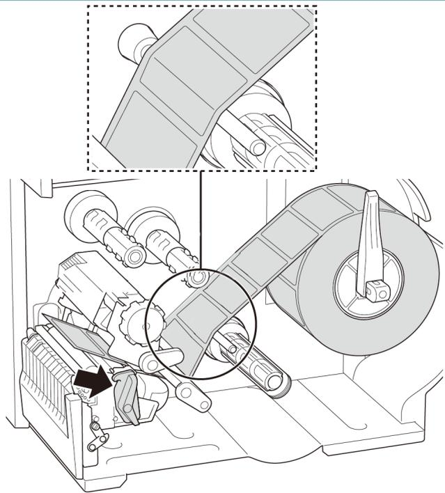
5. Mueva el sensor de medios ajustando el dispositivo de ajuste de posición del sensor de medios. Asegúrese de que la posición del sensor de separación o de marca negra coincida con la posición de la separación/marca negra del rollo de etiquetas.
