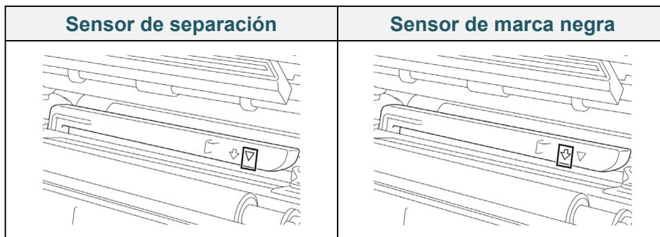
El sensor de separación (sensor transmisivo) detecta el comienzo de la etiqueta y la impresora la hace avanzar a la posición correcta.
