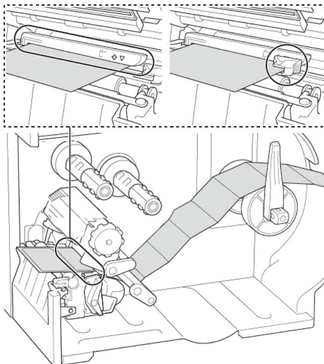
6. Cierre el cabezal de impresión en ambos lados y asegúrese de que encaje en su sitio.
