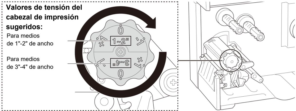
Para obtener la mejor calidad de impresión, ajuste el cabezal de impresión con la rueda de ajuste de tensión del cabezal de impresión. Elija uno de los seis niveles de ajuste de tensión dependiendo del ancho de los medios que utilice (1"-2" o 3"-4").
