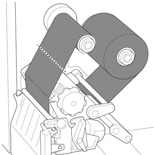
2. Retire la cinta del eje de rebobinado de cinta.
