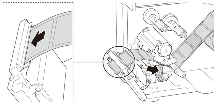
3. Empuje la palanca de liberación del cabezal de impresión y pase la etiqueta a través del amortiguador, el sensor de medios y la guía de etiquetas frontal para instalar el medio.
