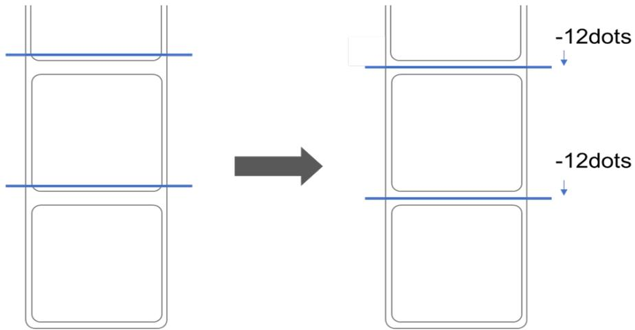
(La posición del corte se puede ajustar según la impresora y los materiales que use).
