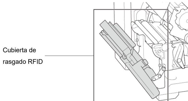
3. Pase los medios RFID a través de la ranura de la cubierta de rasgado.
