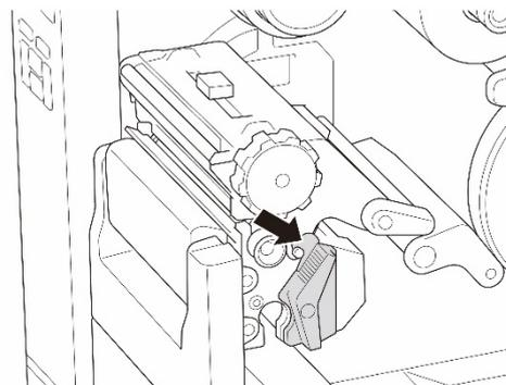
4. Collegare il nastro sotto la barra di guida del nastro e attraverso la fessura del sensore nastro seguendo il percorso di caricamento stampato sul coperchio dei supporti di stampa.
