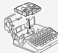
1. Inserte el casete de cinta siguiendo la ilustración que hay debajo del compartimiento de cassette de cinta. Compruebe que el extremo de la cinta apunta hacia la ranura de salida de la cinta.
