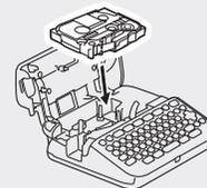
1. Insérez la cassette à ruban en suivant l'illustration sous le couvercle du compartiment de la cassette à ruban. Assurez-vous que le bout du ruban est dirigé vers la fente de sortie du ruban.
