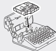
1. Inserire la cassetta nastro seguendo l'illustrazione riportata sotto il coperchio dello scomparto della cassetta nastro. Verificare che la punta del nastro sia rivolto verso la fessura di uscita del nastro.
