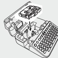
1. Insira o Cartucho de Fita seguindo a ilustração fixada na parte interna da Tampa do Compartimento do Cartucho de Fita. Certifique-se de que a extremidade da fita esteja apontada para a Ranhura de Saída da Fita.
