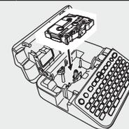
1. Insérez la cassette de ruban en suivant l'illustration sous le couvercle du compartiment de la cassette de ruban. Assurez-vous que le bout du ruban est pointé vers la fente de sortie du ruban.
