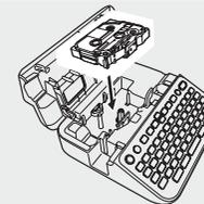
1. Inserte el casete de cinta de acuerdo con la ilustración situada debajo de la cubierta del compartimento del casete de cinta. Confirme que la punta de la cinta apunte hacia la ranura de salida de la cinta.
