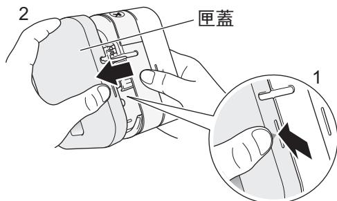
2. 按照外殼內側所標記的圖示裝入標籤帶匣。確保標籤帶對準綠色的標籤帶出口，輕輕將標籤帶匣按入機器中，直到其鎖定到位。
