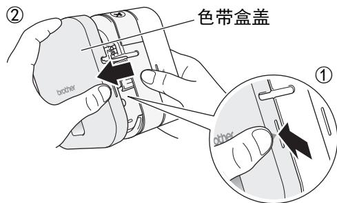
2. 按机壳内侧的标记装入色带盒。确认色带朝向绿色色带出口并将色带盒轻轻按压至标签打印机直至其锁止到位。
