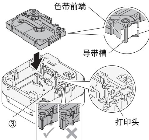
3. 将色带盒盖后部的两个卡钩插入标签打印机的插槽 ④ 内。推动闭合的色带盒盖 ⑤，确保其锁止到位。
