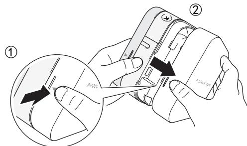
2. 按照机壳内侧的标记安装六节电池。注意正负极，确保电池负极端与电池槽内的线圈匹配。
