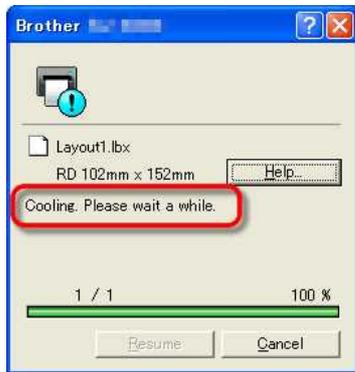
Sobald die Temperatur ausreichend gesunken ist, wird der Druckvorgang fortgesetzt.
