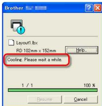
Una vez que la temperatura haya bajado lo suficiente, la impresión se reanuda automáticamente.
