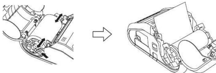
4. Fermez le compartiment du RD Roll en appuyant sur le centre du couvercle jusqu'à ce qu'il s'enclenche.
