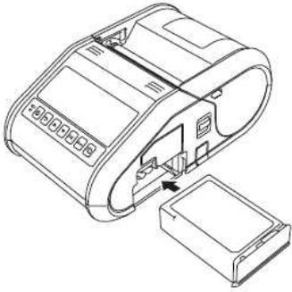
2. Avec la pile insérée et en poussant légèrement la pile dans la cavité, abaissez le loquet de la pile jusqu'à ce qu'il s'enclenche et verrouille la pile en place.
